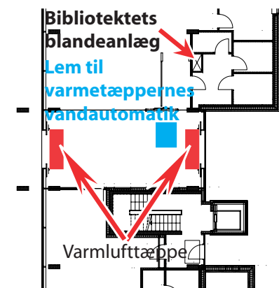
Eksempel på placeringer af tekniske anlæg
